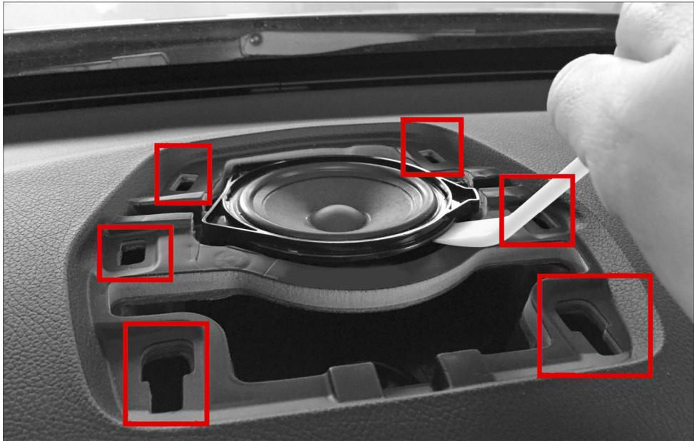
Der originale Lautsprecher ist an drei Punkten auf die Verkleidung gesteckt. Nutzen Sie gegebenenfalls einen Plastikkeil zum Heraushebeln des Lautsprechers. Nutzen Sie zum Entriegeln der Anschlussstecker entweder einen schmalen Schraubenzieher oder eine Büroklammer.
